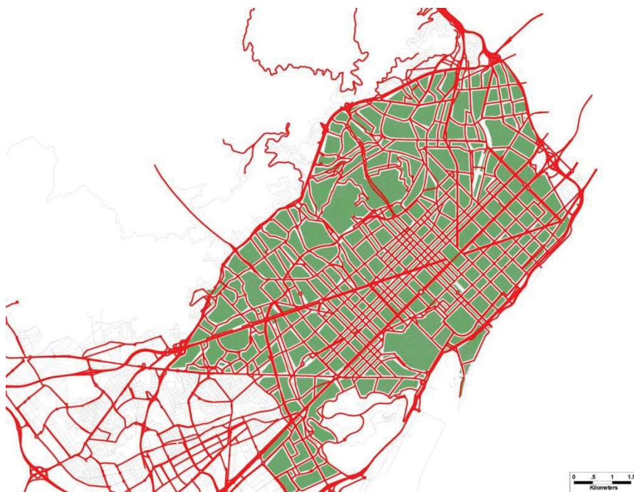
Graf de simulació de l'escenari de Superilles. A l'interior de les Superilles (zones en verd), es modifiquen capacitats i velocitats per restringir el trànsit de pas. Font: BCNecologia.
