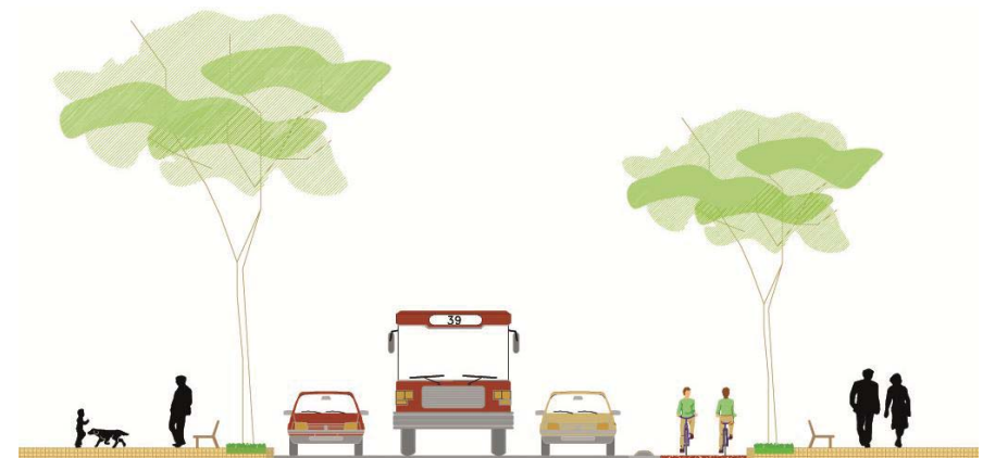
Esquema de secció tipus de carril bici bidireccional segregat per una banda d'estacionament.
