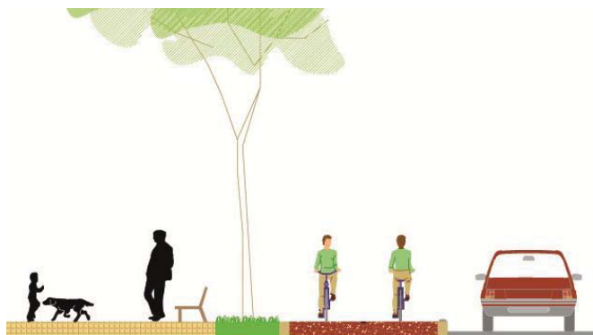
Esquema d'una secció tipus amb carril bici sobre la vorera. Font: Elaboració pròpia
