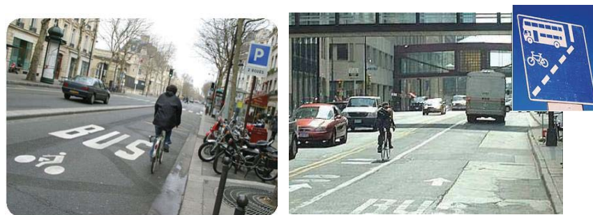
Carril bus autoritzat per a bicicletes a París; carril bus amb franja diferenciada per a bicicletes i senyalització de coexistència amb el bus.
